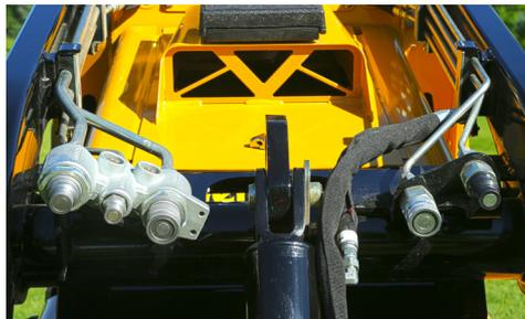
**HIDRÁULICO COMPLETO.** Vem de série com um circuito hidráulico auxiliar duplo com alto fluxo para alimentar os acessórios mais exigentes e um de baixo fluxo para dar ao operador o máximo controle.
