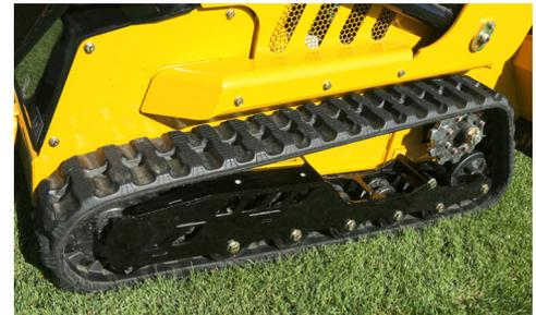
**ADAPTA-SE AO DESAFIO.** Com uma placa de montagem universal, rastros de 18 ou 23 cm com baixa pressão ao solo e várias escolhas de motor, a S925TX tem todas as opções para aumentar a produtividade em obra.
