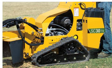
**DISCO DE CORTE E RASTOS COM TRANSMISSÃO HIDRÁULICA.** A transmissão hidráulica reduz o risco de reparações e a necessidade de manutenção.
