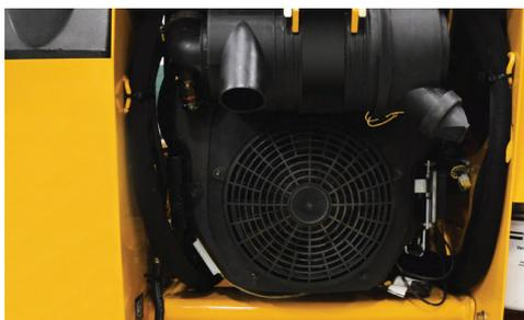
**MOTOR DE 25 HP (18,6 KW) COM INJEÇÃO ELETRÓNICA DE COMBUSTÍVEL.** Arranca facilmente durante o tempo frio, não necessita de cabo de acelerador e oferece uma maior poupança de combustível face aos motores a gasolina com carburador.
