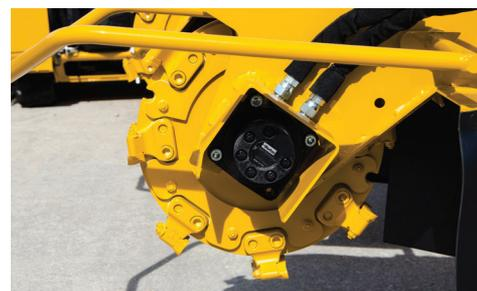
**SISTEMA DE CORTE PATENTEADO YELLOW JACKET™.** O sistema de corte Yellow Jacket exclusivo da Vermeer permite uma manutenção rápida e fácil, bem como uma maior vida útil dos suportes e dos dentes de corte.
